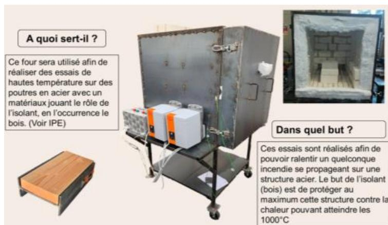
Fig. 1 : Four d'essai
