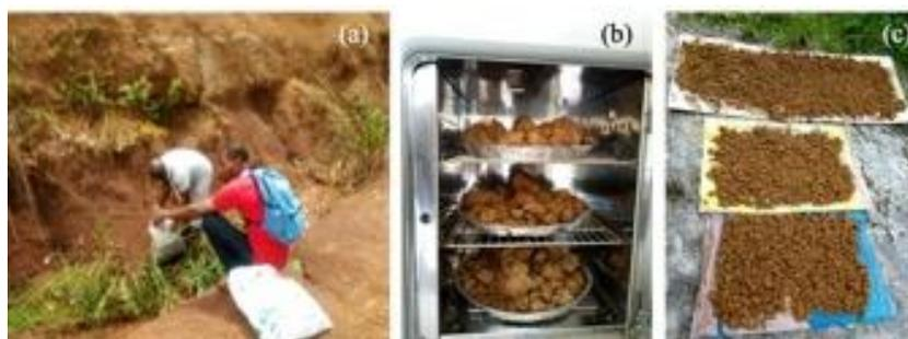
Fig. 1: Argile : collecte de l'argile (a) ; séchage à l'étuve (b) ; séchage naturel
