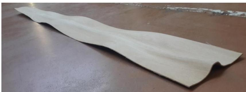
Fig. 9 : Défaut typique des placages rejetés du fait de leur ondulation
