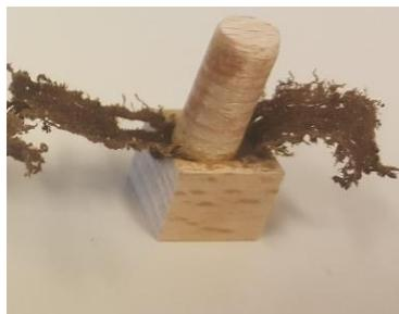
Fig.2 : Echantillon soudé :  $P_s=6\text{MPa}$ ,  $v=0.44\text{m.s}^{-1}$ .
