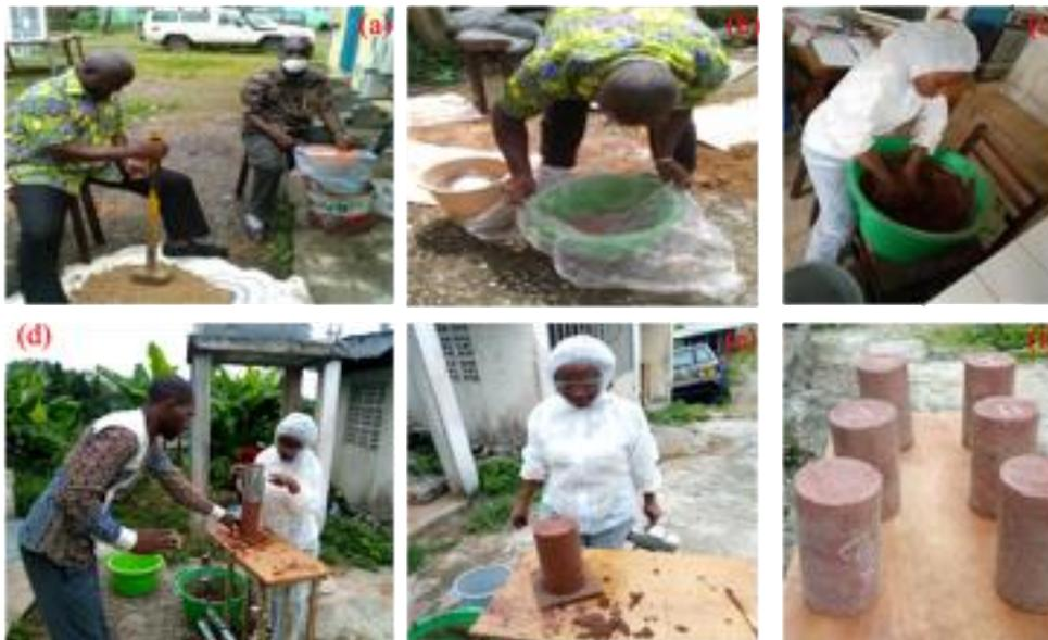
Fig. 2: dispositif expérimental : broyage (a) ; tamisage (b) ; malaxage (c) ; moulage à l'aide d'un moule cylindrique (d) ; briquette fraîche (e) ; briquette séchée (d)
