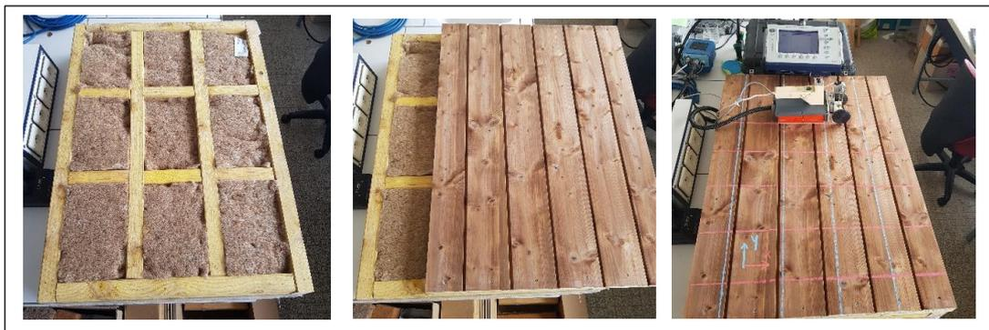
Fig. 2 : Maquette du mur à ossature bois : montants bois avec isolant (à gauche), bardage extérieur avec tasseaux bois (au centre) et grille de mesures radar à l'échelle de la paroi (à droite)
