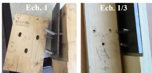
*Fig. 6 : Rupture des assemblages : à gauche échelle 1, à droite échelle 1/3*
