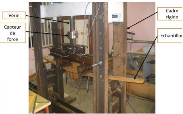
Fig. 2 : Essai statique quatre points
