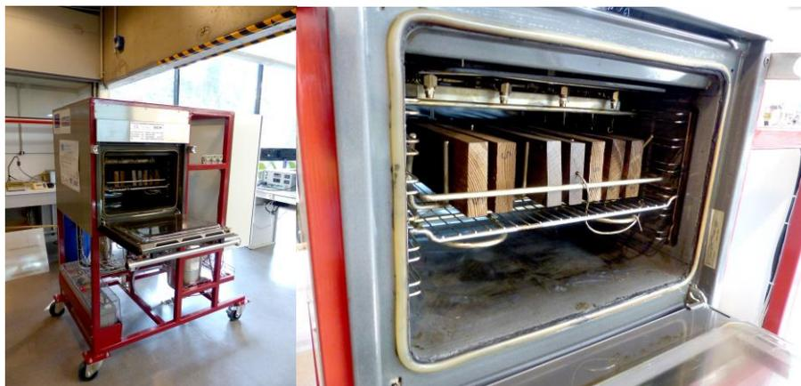
Fig. 1 : Le pilote de traitement thermique.
