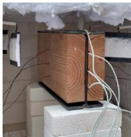
Fig. 3 : Poutre entièrement enrobée (pin)
